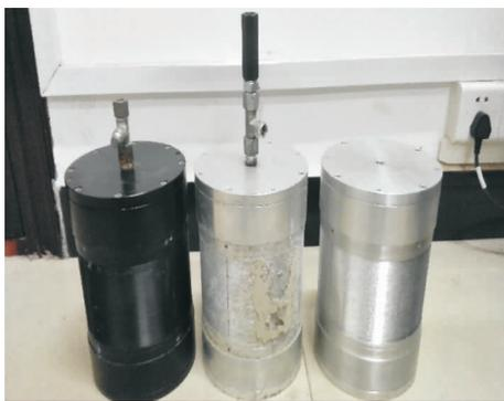
图 3 不同孔径单节试验孔隙水采样柱
