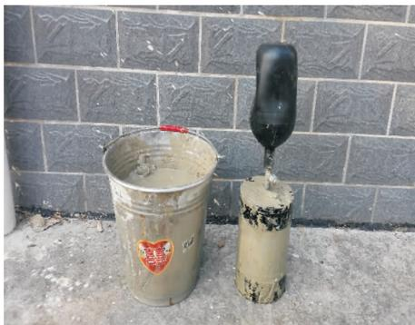
图 7 单节试验孔隙水采样柱过滤设备
