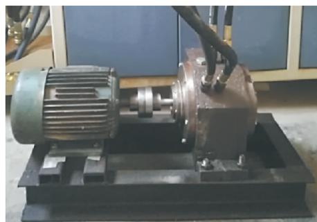
图 8 实验室转阀样机及电机
