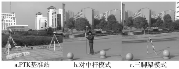
图5 RTK 基准站及流动站模式
