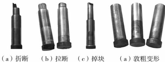
图3 试生产时凸模损坏的几种形式
