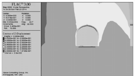
(b) 支护后竖直方向位移云图
