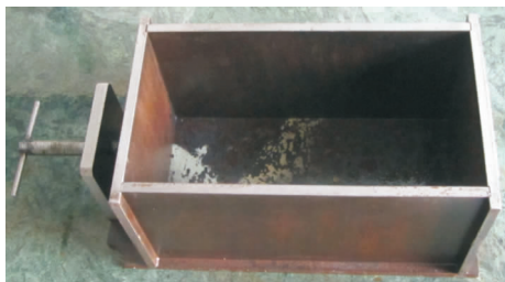
图2 大尺寸试样制备模具
