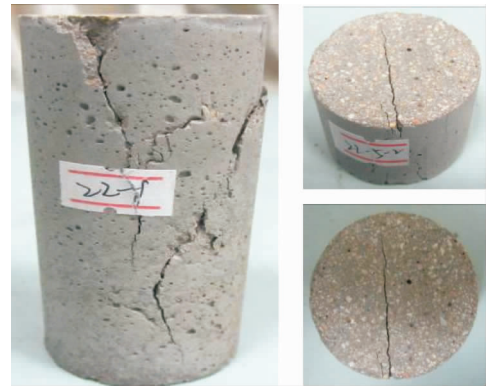
图1 第22组试样的破坏形态
