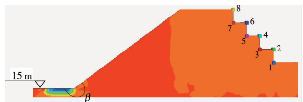
图7 爆源在15 m水平时的边坡数值模型
