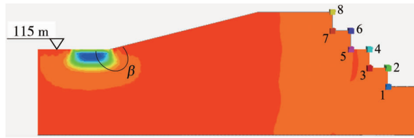
图4 爆源在115 m水平时边坡数值模型
