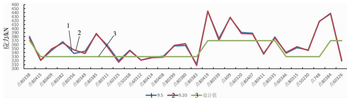
图14 锚索应力监测曲线(2017年9月)
