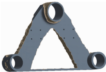
图 8 导向架拓扑优化结果
