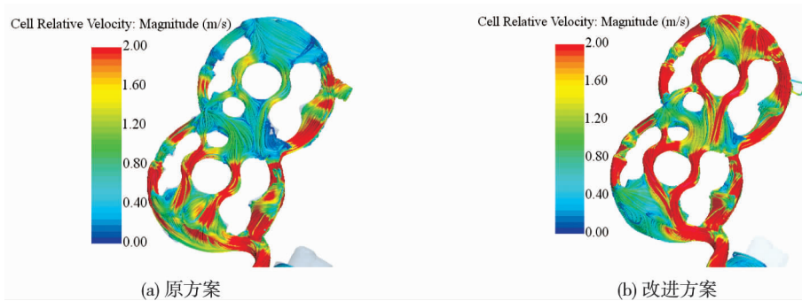
图 13 冷却水套结构改进前后冷却水套速度流线分布
