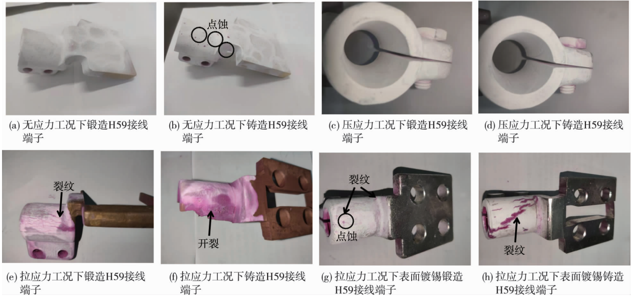
图 4 2 种 H59 接线端子氨熏腐蚀形貌
