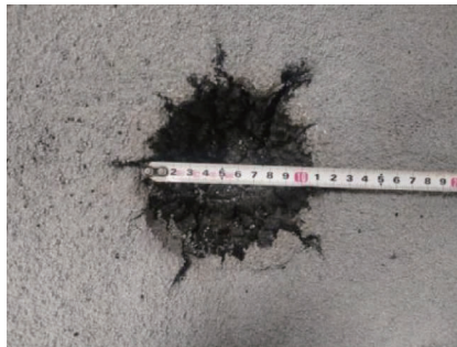
图 13 模型试验爆腔
