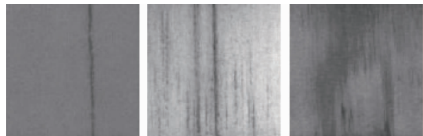
(a) 裂纹缺陷特征 (b) 擦划伤缺陷特征 (c) 擦划伤缺陷特征
