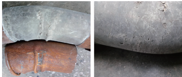
图3 管内核心陶粒混凝土破坏细节
