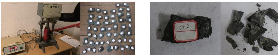
图4 煤岩块点载荷试验
