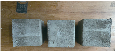
图 2 养护完成的气泡混合轻质土试件
