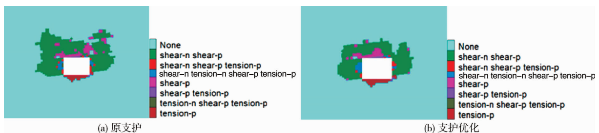
图 14 12110 回采巷道围岩垂塑性区
