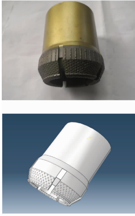
图 1 金刚石钻头有限元模型与实物
